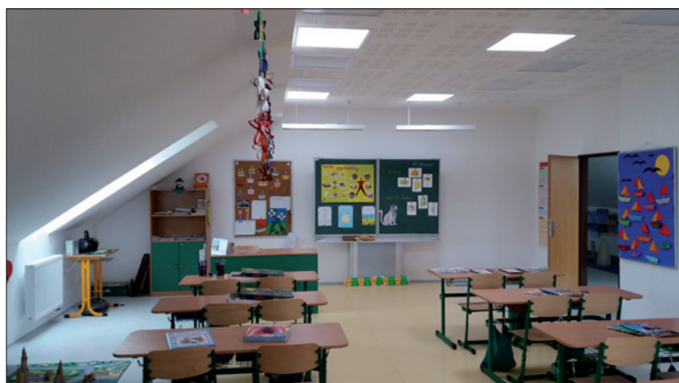
Obr. 4. Herna, učebna – šest svět- lovodů Solatube 330DS- -530mm
