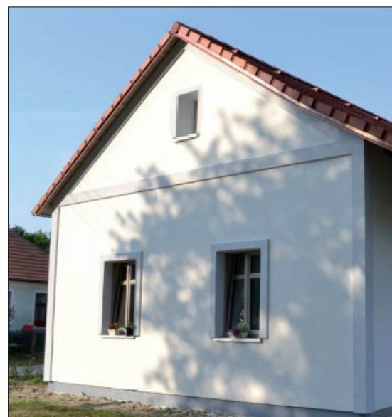
Obr. 3. Průčelí vesnického domu, které je zčásti osvětlené přímým slunečním zářením; osluněná část průčelí se jeví oproti obloze jako světlejší ( k_m > 1,0! ) a zároveň je patrný rozdíl mezi jasem osluněné a neosluněné části tohoto průčelí
