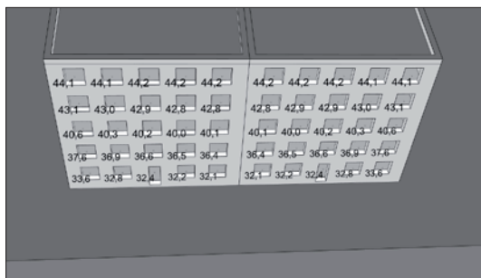
Obr. 11. Činitele denní osvětlenosti roviny zasklení oken (hmota objektu upravená světelným technikem)
