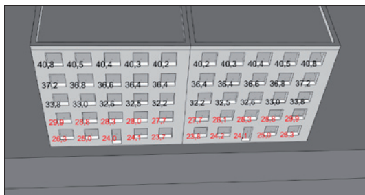
Obr. 10. Činitele denní osvětlenosti roviny zasklení oken (hmota objektu upravená architektem)
